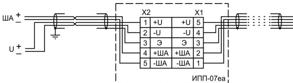
U - внешний развязанный источник питания  $U_n=24\text{ В} \pm 10\%$ ; ША - адресная линия связи ППКиУП “Vesta 01F” или модуля сопряжения “МС-5”; Э - экран кабеля. Клеммы разъемов X1 и X2 являются проходными.
