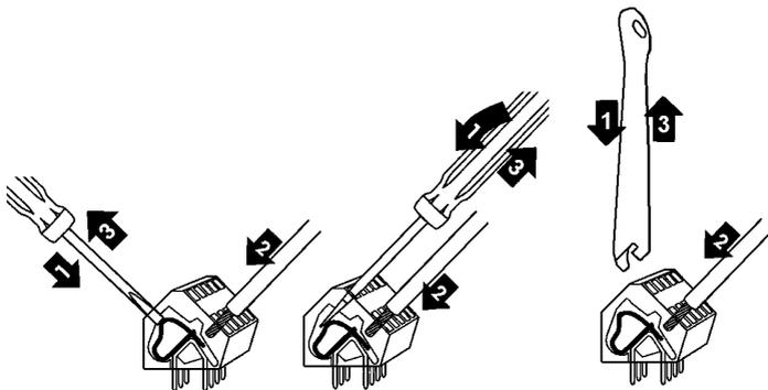
Для подключения проводников в клеммы:
